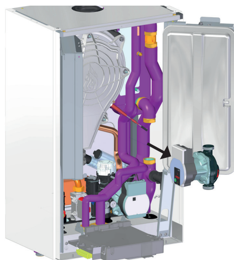
fig. 65 - Sostituzione/manutenzione circolatore della pompa di calore
